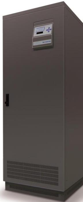
Le apparecchiature della serie STS sono dei sistemi statici di trasferimento automatico trifase in grado di commutare automaticamente o manualmente fra due sorgenti di alimentazione in corrente alternata garantendo tempi di trasferimento inferiori ad  $\frac{1}{4}$  di periodo.
